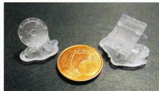
**Un coperchio di un cilindro (a sinistra) e quello di un cassetto di distribuzione (a destra); dall'ingrandimento si nota come la stereolitografia permetta di ottenere bulloni veramente esagonali!**
